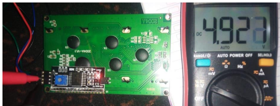
Gambar 7 Pengukuran Tegangan LCD
